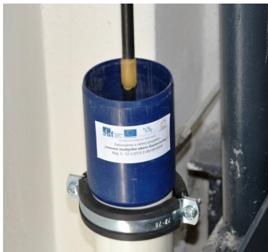
Obr. 15 Detail inklinometrického kabelu se značkou označující krok měření
