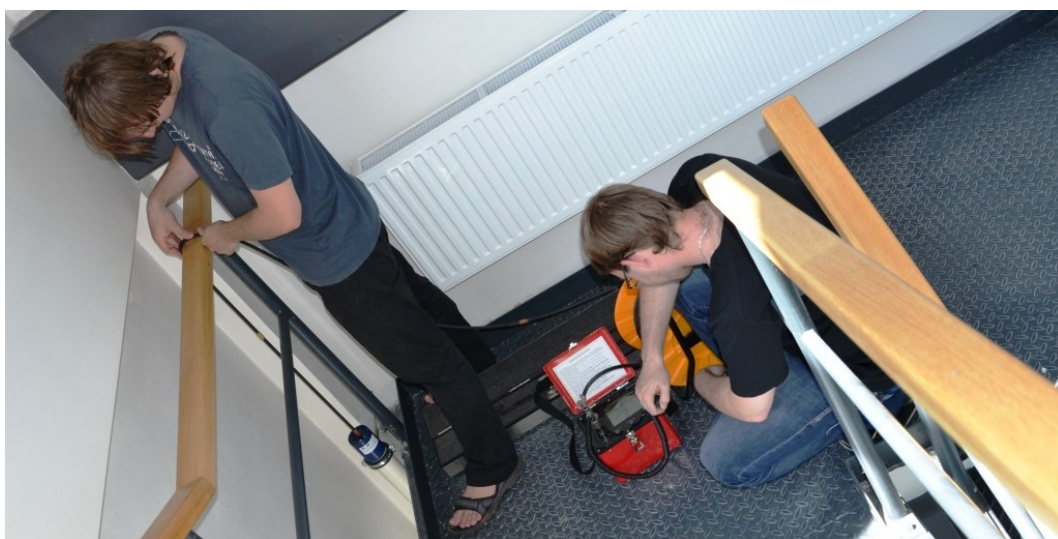
Obr. 13 Inklinometrické měření ve výpažnici umístěné v budově FAST, VŠB-TU Ostrava
