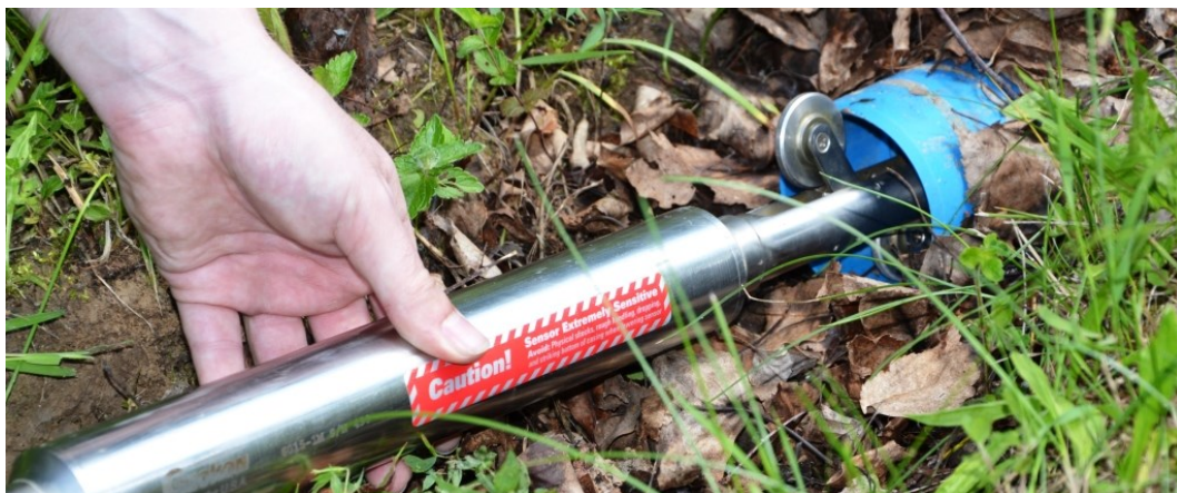
Obr. 11 Detail orientace koleček do vodících drážek
