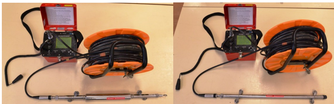
Obr. 8 Zkompletovaná inklinometrická souprava – horizontální resp. vertikální inklinometr
