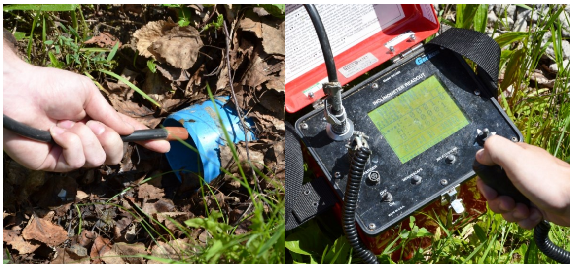
Obr. 12 Detail inklinometrického kabelu se značkou, která označuje krok měření a odečet příslušné hodnoty v příslušném kroku za pomoci stanice
