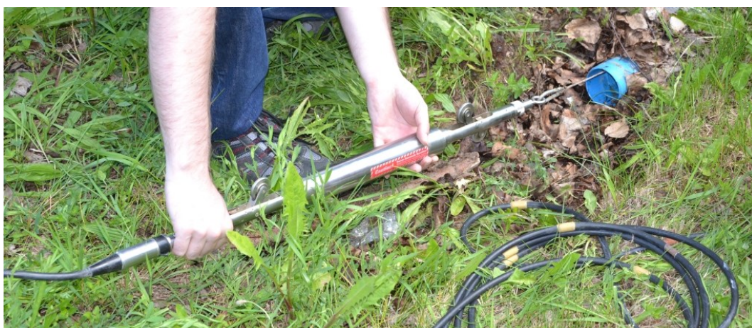
Obr. 10 Zavádění inklinometrické sondy do výpažnice
