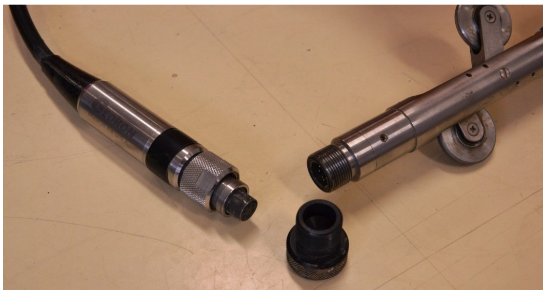
Obr. 7 Detail připojení inklinometrické sondy k inklinometrickému kabelu
