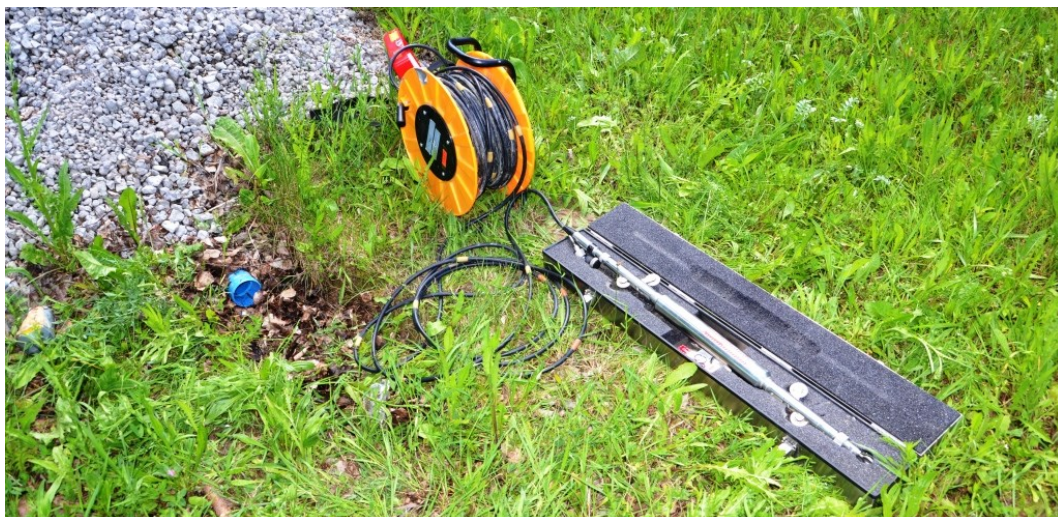
Obr. 9 Horizontální inklinometr připravený k měření (násyp opatřený inklinometrickou výpažnicí v areálu FAST, VŠB-TU Ostrava)
