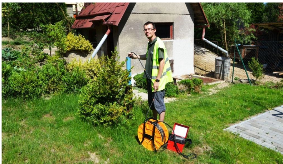
Obr. 17 Spouštění inklinometrické sondy na dno vrtu
