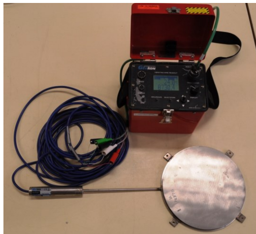
Obr. 8 Plochá tlaková buňka Model 4810 – 350 kPa připojená ke stanici Model GK-403
