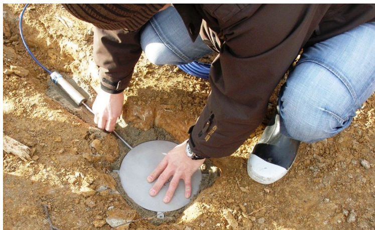
Obr. 10 Instalace ploché tlakové buňky model 4810 do pískového lože
