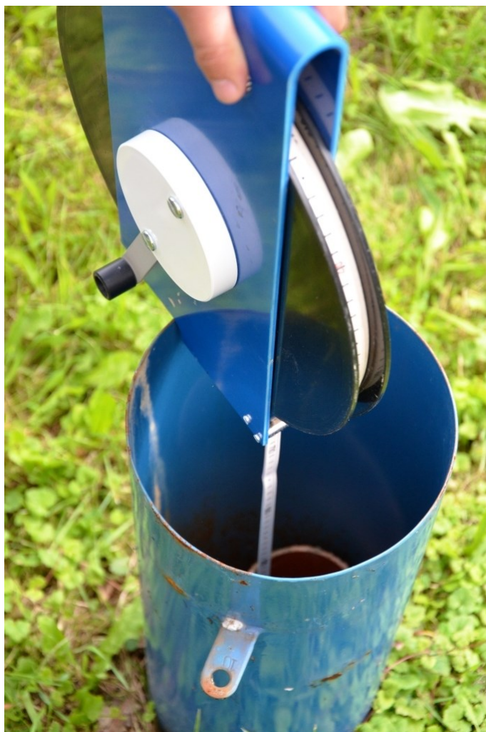
Obr. 7 Zastižení hladiny podzemní vody – optická a akustická indikace
