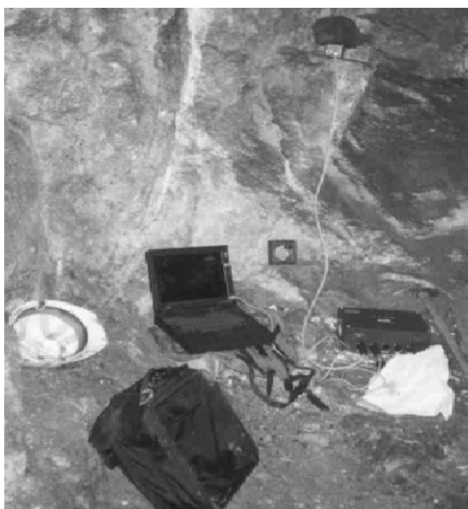
Obr. 13.3 - Aplikace monitorovací aparatury Geosig GCR - 16 při monitoringu v historickém dole Jeroným; (foto Doc. Kaláb, Ústav geoniky AV ČR)
