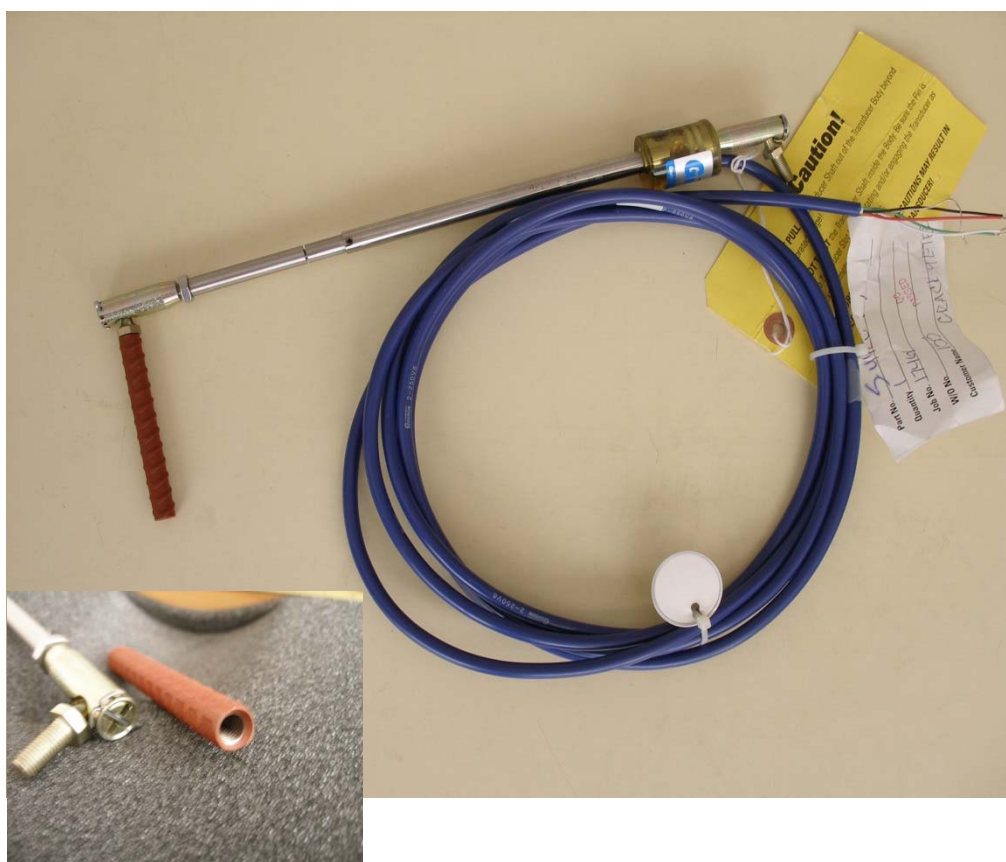
Obr. 5.2 - Strunový dilatometr (katedrální foto)
