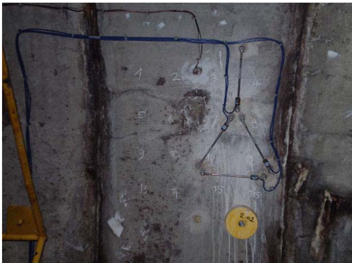
Obr. 5.4 – Schéma rozmístění skupiny dilatometrů pro monitoring trhlin (zdroj: časopis Stavebnictví, 09/08, autoři: Bubeníček, Vaníček, Záleský)
