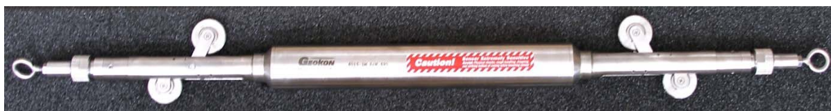
Obr. 9.2 - Horizontální inklinometrická sonda Geokon (katedrální foto)
