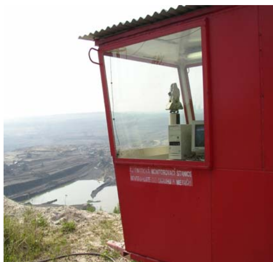
Obr. 9.1 - Geodetická automatická monitorovací stanice – Doly Nástup Tušimice (foto: Ing. Větrovský, Ph.D.)
