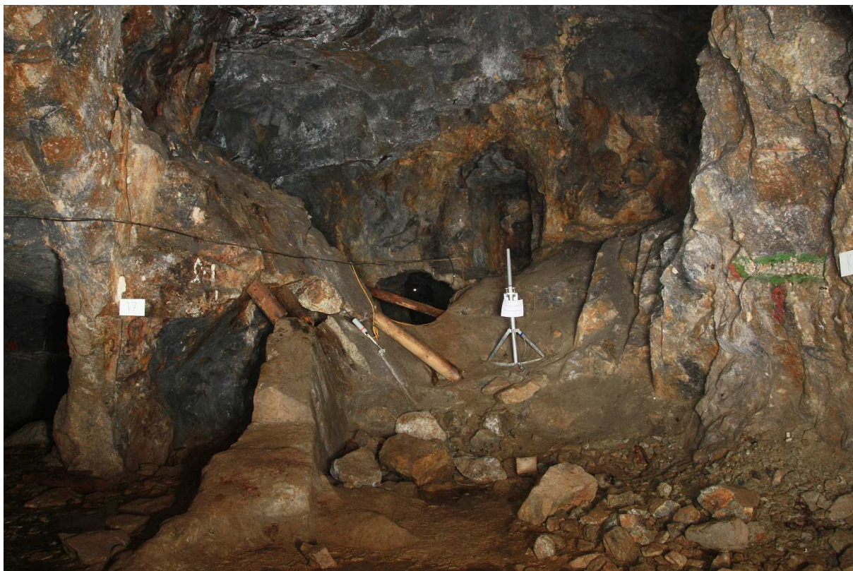
Komora K2 s laserovým dálkoměrem a čidlem na měření rozevírání puklin KD6
