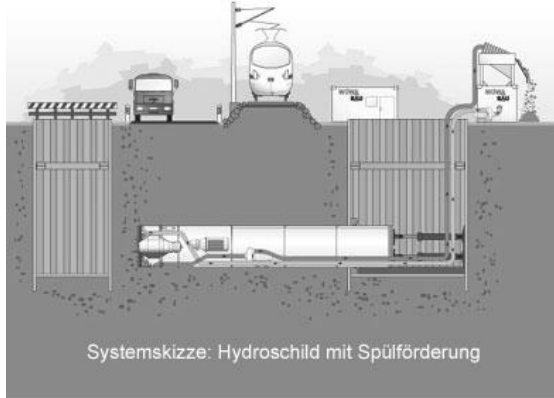
Zatlačování pomocí hydroštitu
